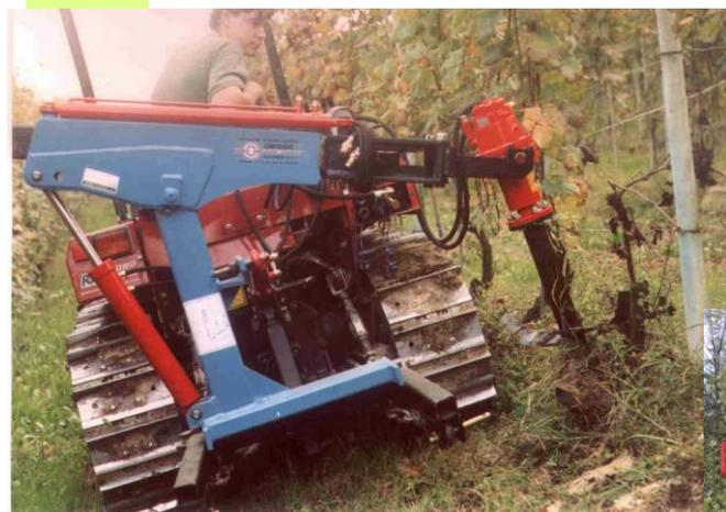
Trivella Idraulica laterale Tipo PLI-TR-OMR
