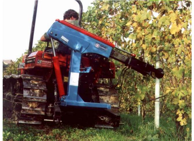
**Attrezzatura Multifunzione con Pinza piantapali e cavapali Tipo PLI-PZ**
